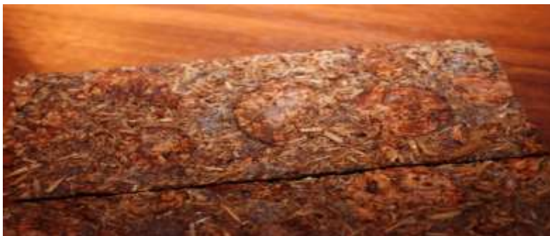
Рис 2. Вариант декоративной плиты с наружными слоями из крупных кусков пробки
