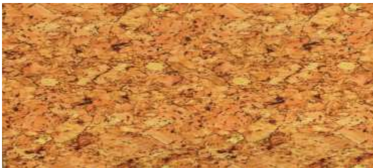
Рис 1. Вариант декоративной плиты с наружными слоями из измельченной пробки
